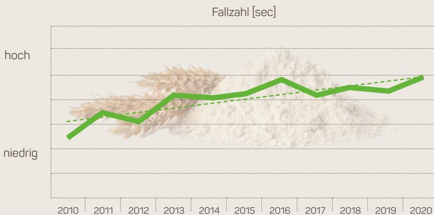
Eine hohe Fallzahl bedeutet eine geringere mehleigene Enzymaktivität. Dies verzögert die Teigentwicklung und führt zu weniger lebendigen Gebäcken und einer trockeneren Krume.
